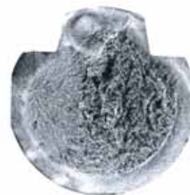
Bild 2: Ermüdungsfehler durch Torsion
