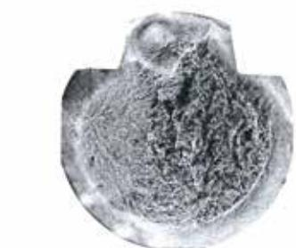
**Fig. 2:** rottura a fatica causata da concentrazione negli intagli della sollecitazione a torsione
