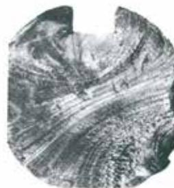
**Fig. 3:** tipica frattura a fatica in albero con sede di chiavetta
