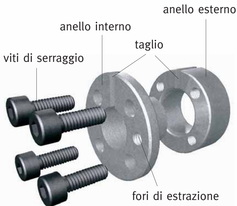
Componenti di un calettatore MAV Serie Mini
