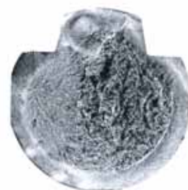
Fig. 2: rottura a fatica causata da concentrazione negli intagli della sollecitazione a torsione
